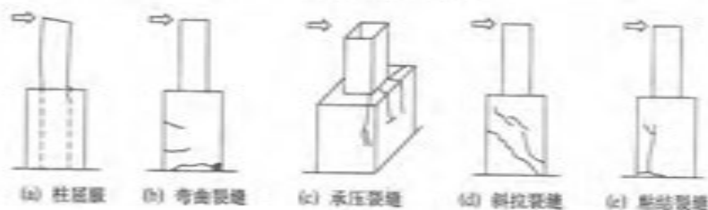
图4 外包式柱脚的受力机制
